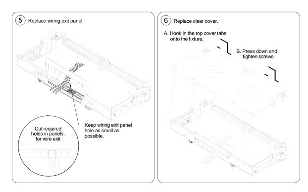
Figure 2-9. Wiring the Terminal Module
