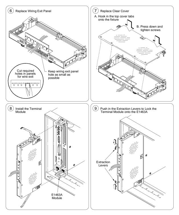
Figure 1-11. Wiring a Terminal Module
