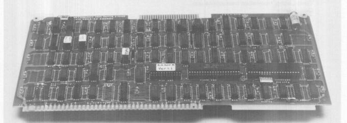
FIG. 1: ZX-200A CONTROLLER BOARD
