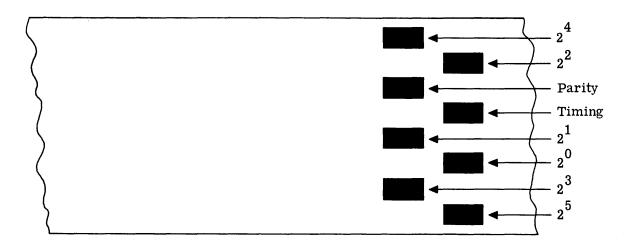
Figure D2-1. Bit Structure
