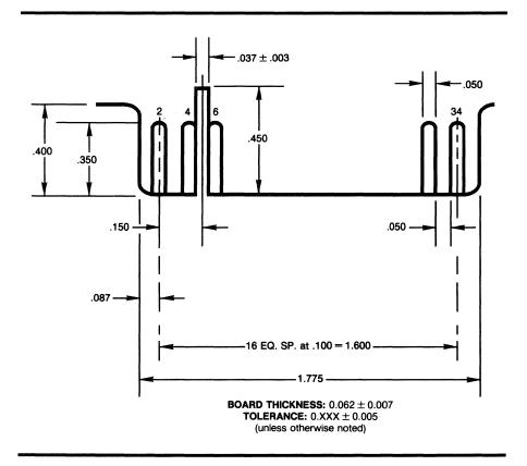
GROUND **SIGNAL RTN PIN** PIN SIGNAL NAME -HEAD SELECT 23 2 3 4 -HEAD SELECT22 5 6 -WRITE GATE 7 -SEEK COMPLETE 8† 9 10† -TRACK Ø 11 12† -WRITE FAULT 13 14 -HEAD SELECT 2º -RECOVERY MODE 15 16 -HEAD SELECT 21 17 18 -INDEX 19 20† 21 22† -READY 23 24 -STEP -DRIVE SELECT 1 25 26 27 28 -DRIVE SELECT 2 29 30 -DRIVE SELECT 3 31 32 -DRIVE SELECT 4 33 34 -DIRECTION IN †STATUS ENABLED WITH DRIVE SELECT
