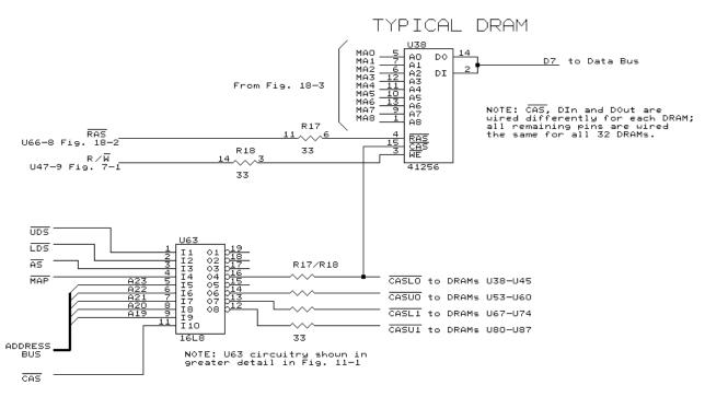
Fig. 18-4. DRAM IC wiring.
