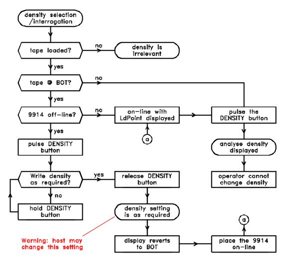
FIGURE 3.8 FRONT PANEL DENSITY SELECTION / INTERROGATION
