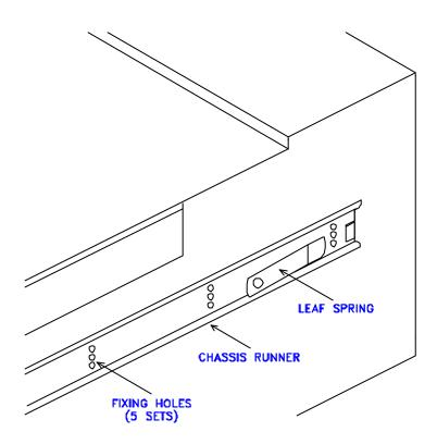
FIGURE 2.3.2 CHASSIS RUNNER ORIENTATION
