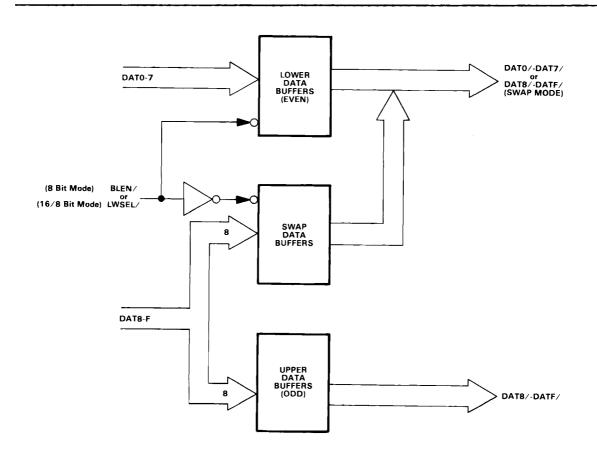
Figure 3-4. Byte Swap Block Diagram
