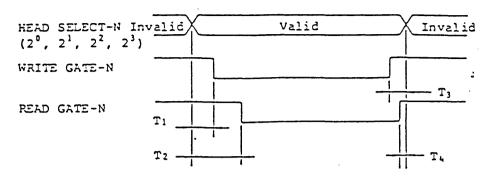
$T_1 > 1 \mu s$ ,  $T_2 > 20 \mu s$ ,  $T_3 > 1 \mu s$ ,  $T_4 > 0 \mu s$
