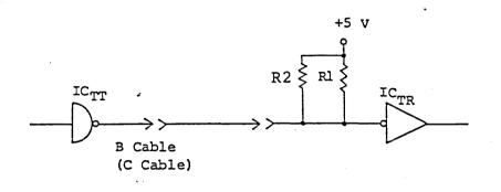
IC<sub>TT</sub>: 7438 IC<sub>TR</sub>: 74LS14/7414/74LS240 Rl : 220 $\Omega$  +5% R2 : 330 $\Omega$  +5%
