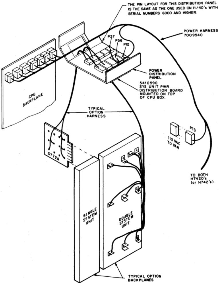
**INSTALLATION OF SYSTEM UNITS, EARLY SYSTEMS, PDP-11/45 CABINET SERIAL NUMBERS LESS THAN 2000**
