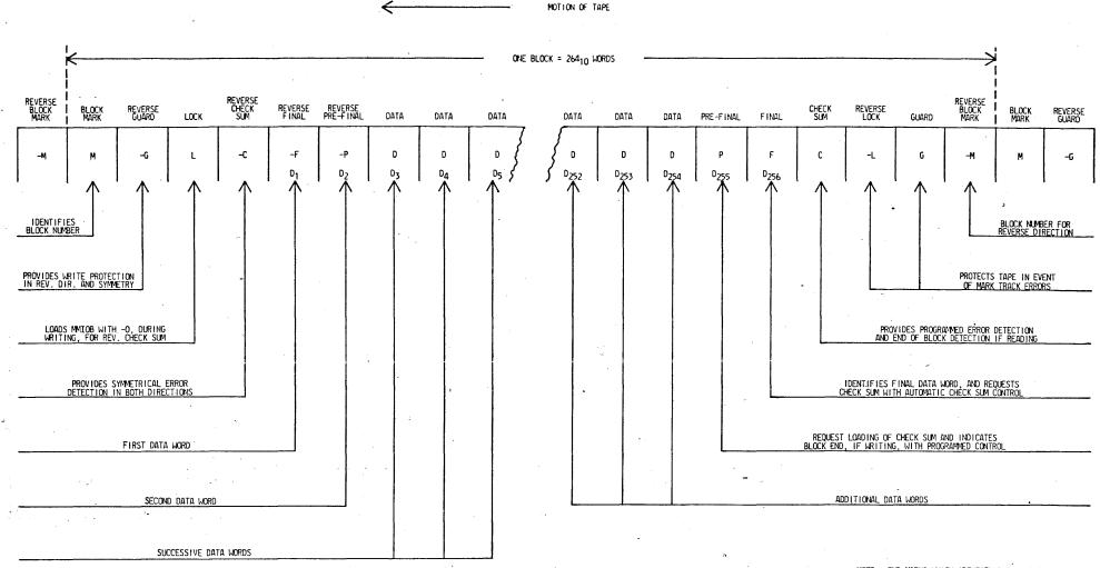
NOTE: END MARKS WHICH IDENTIFY THE PHYSICAL ENDS OF THE TAPE, ARE THE ONLY MARKS NOT SHOWN.
