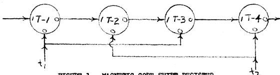
FIGURE 1 - MAGNETIC CORE SHIFT REGISTER
