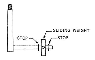
Figure 4-2. Drag Adjust Tool
