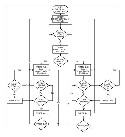
FIGURE 4 - TRANSMIT BUFFER OPERATION
