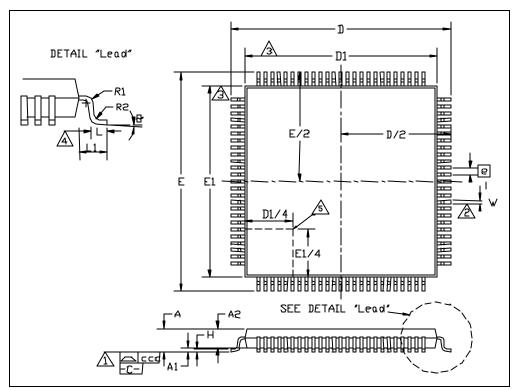
FIGURE 6 - 100 PIN TQFP PACKAGE
