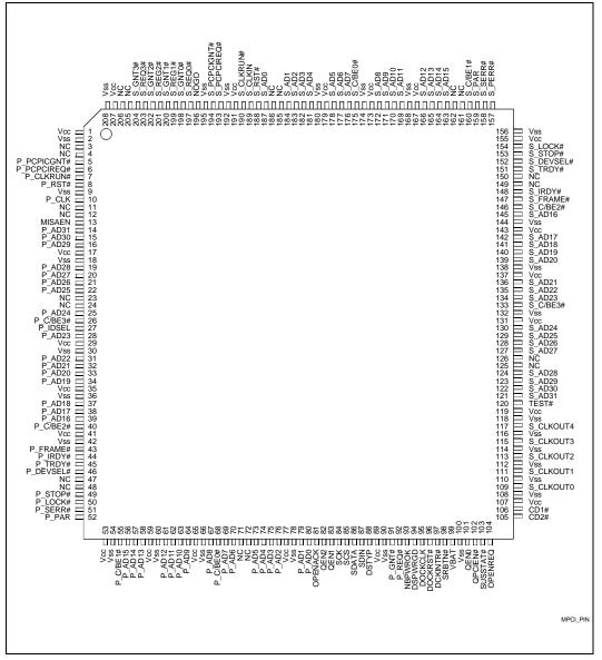
Figure 3. 82380FB Pinout
