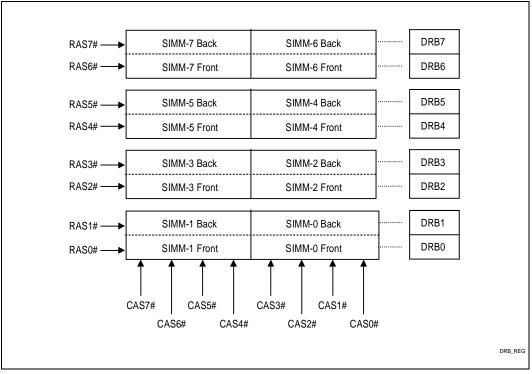
Figure 2. SIMMs and Corresponding DRB Registers
