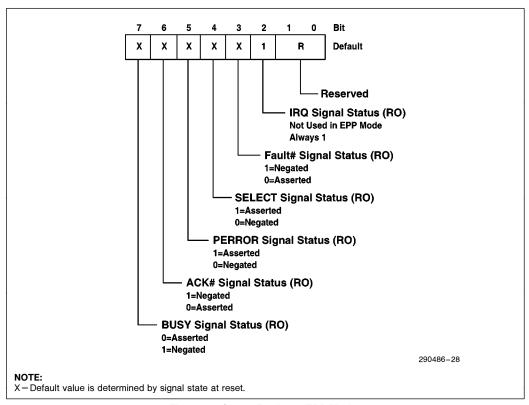
Figure 28. Status Register (EPP Mode)
