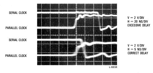
B. OVERLAPPED, EXPANDED WAVEFORMS
