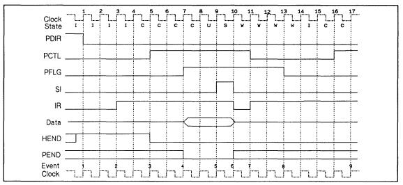
Figure 3-9. Input Full Master Handshake
