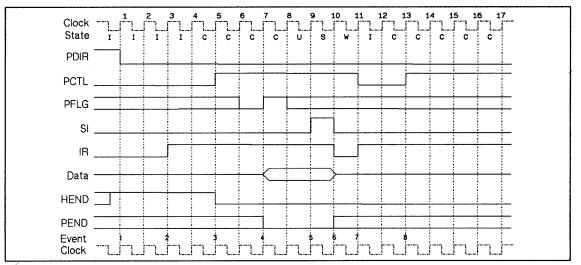
Figure 3-6. Input FIFO Handshake
