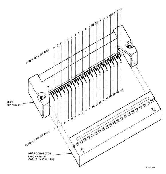
Figure 5-5 J1 or J2 Connector Pin Locations
