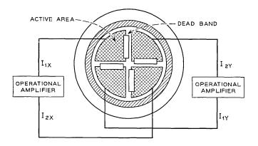
Fig. 7-Photo diode.
