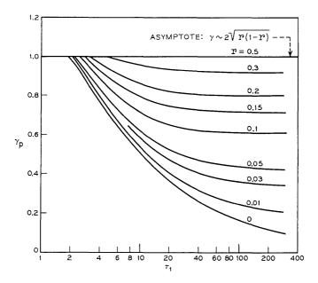
Fig. 6— $\gamma_p$  versus  $\tau_1$  with parameter r.
